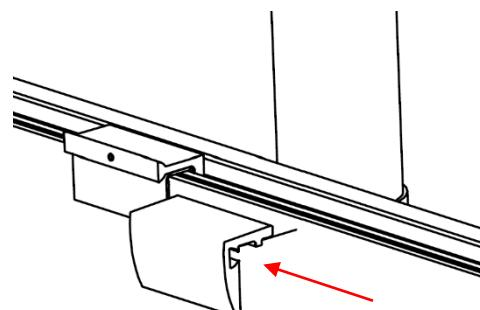
Positionieren Sie die Tragwinkel der Halter auf der Schiene.
