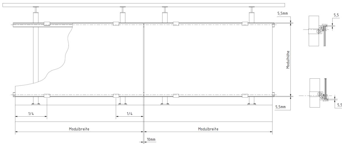
Die Länge der Fassade entspricht der Breite des Moduls x Anzahl der Module + 10 mm Abstand zwischen den einzelnen Modulen:  $[L=(NxIm)+(N-1)\times10= \text{_____} \text{mm}]$
