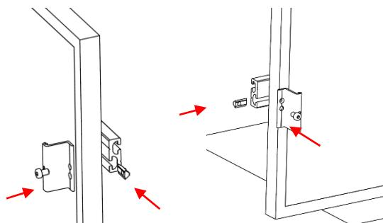
Montage der Abrutschsicherung an das Tragprofil. Die Position des unteren Tragprofils muss ca. 20 cm (+/- 2cm) von der Modulkante entfernt sein.
